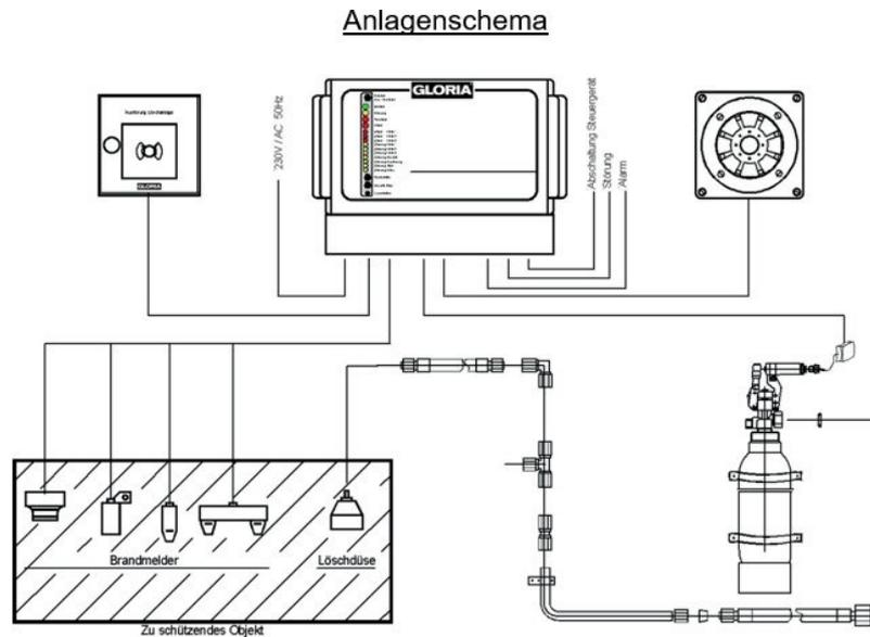
Aufbau der Hauptsystembaugruppen: Löschmittel, Löscher, Löschmittelausbringung, Steuergerät, Brandmelder und Verkabelung
