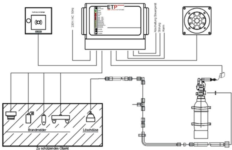
Aufbau der Hauptsystembaugruppen: Löschmittel, Löscher, Löschmittelausbringung, Steuergerät, Brandmelder und Verkabelung
